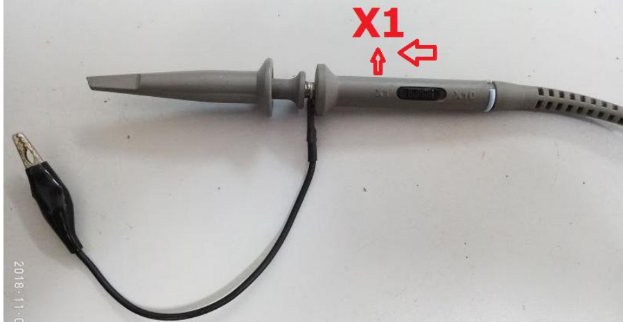
Hình 2.6. Chọn thang X1 trên dây đo máy dao động ký
