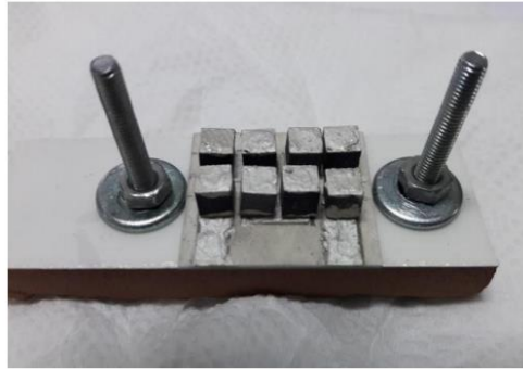
Hình 3.8 Trái: Tạo điện cực cho chân n, p, đế ceramic Phải: Kẹp linh kiện chuẩn bị nung
