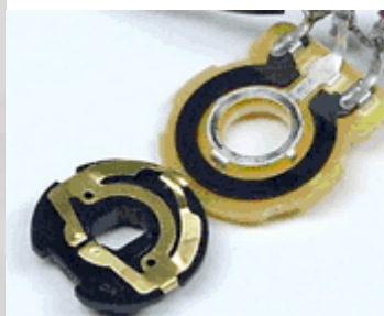
Cấu tạo trong triết áp
