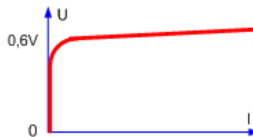
Đường đặc tuyến của điện áp thuận qua Diode
