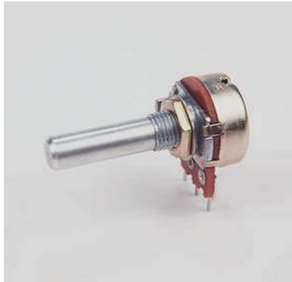
Triết áp 100K\Omega dùng để lắp mạch Bass treec và triết áp Volume
