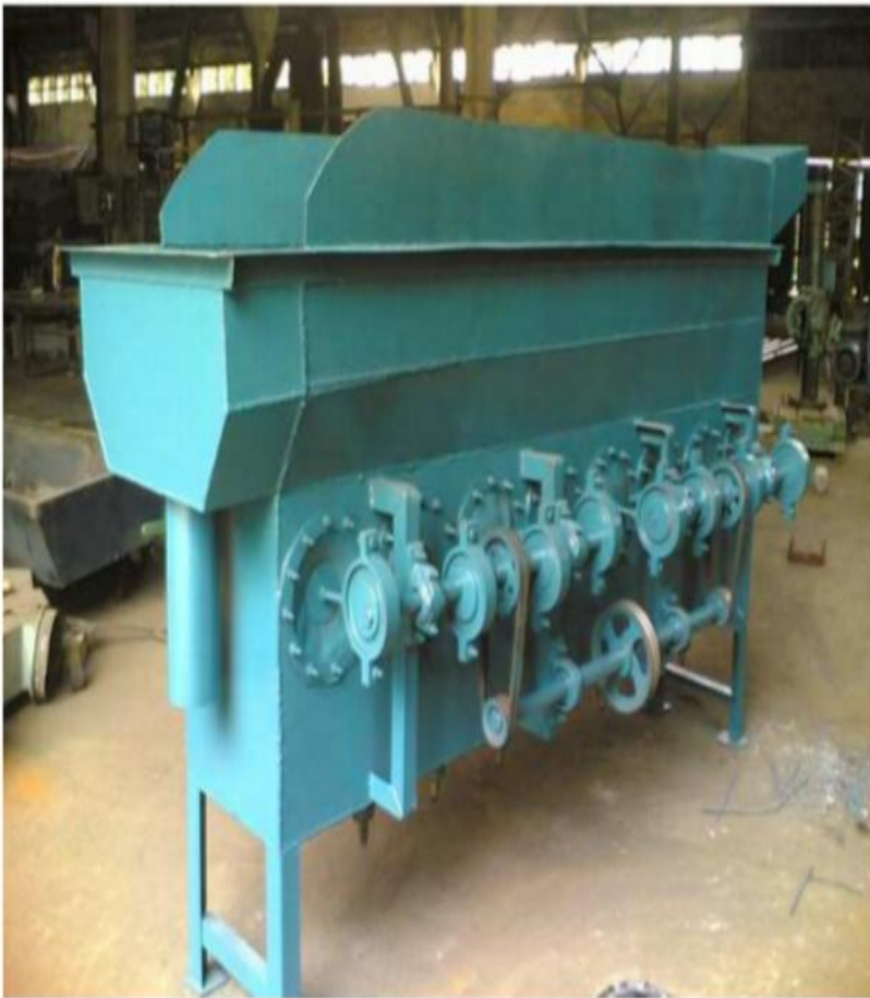
Hình: thiết bị lắng có tấm chắn nghiêng.
