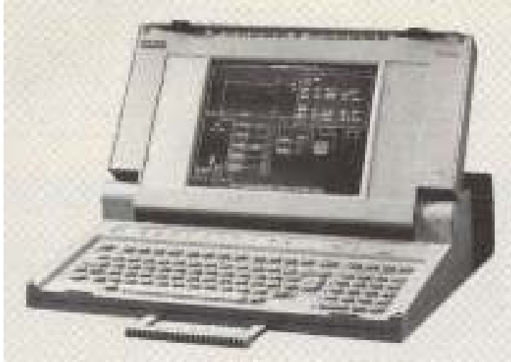
Hình 1.24. Thiết bị lập trình chuyên dụng PG 730C
