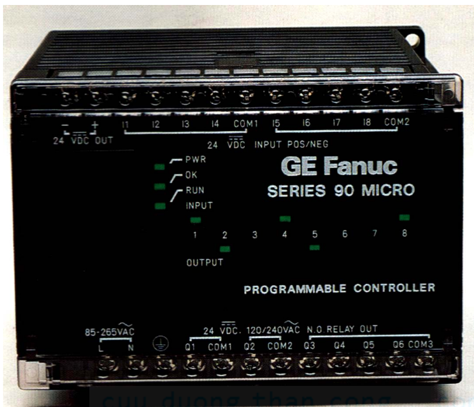
Hình 1.4. Micro-PLC xê ri 90 của Fanuc
