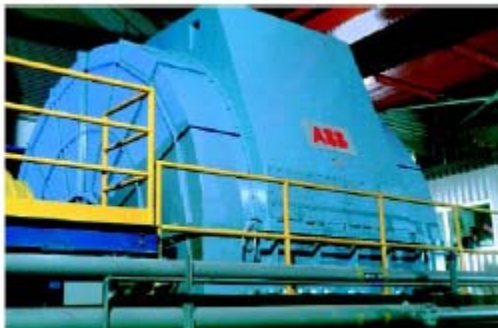
Figure 1.9 Điều khiển máy điện đồng bộ 6 pha - Six-phase synchronous motor (100MW, 12.5KV, 2.8KA)
