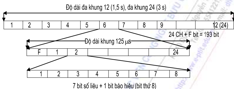
Hình 2.4: Cấu trúc đa khung PCM 24
