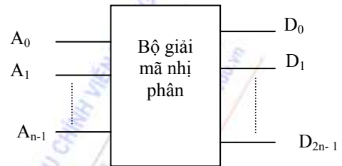
Hình 3-13. Sơ đồ khối của bộ giải mã nhị phân
