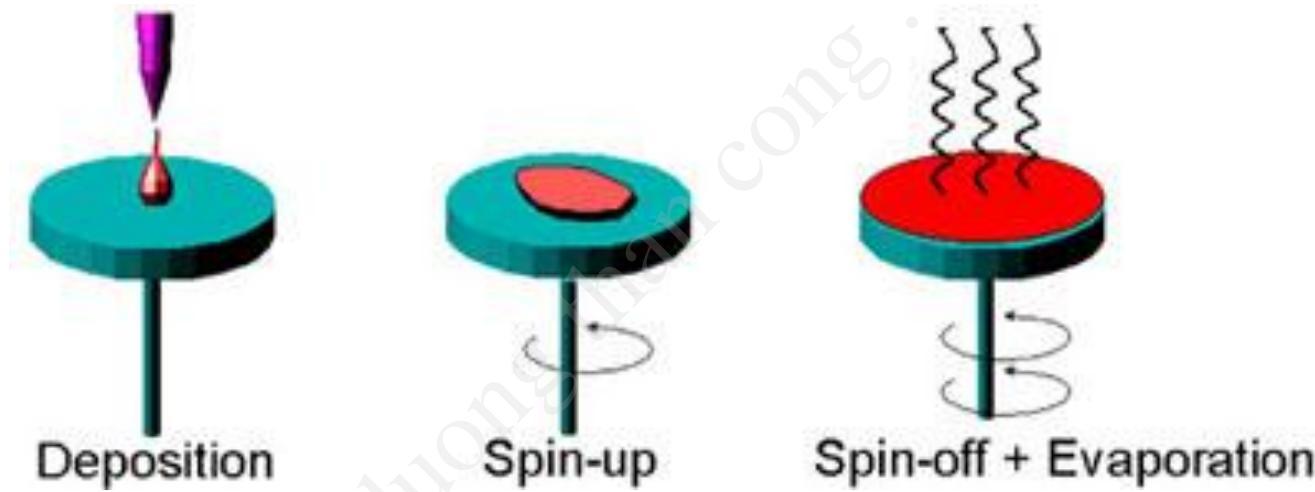
*Mô hình cơ bản tạo màng bằng phương pháp phủ quay.*
