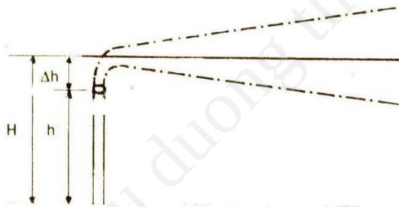
Hình 7. Sơ đồ tính độ cao phụt của luồng khí thải
