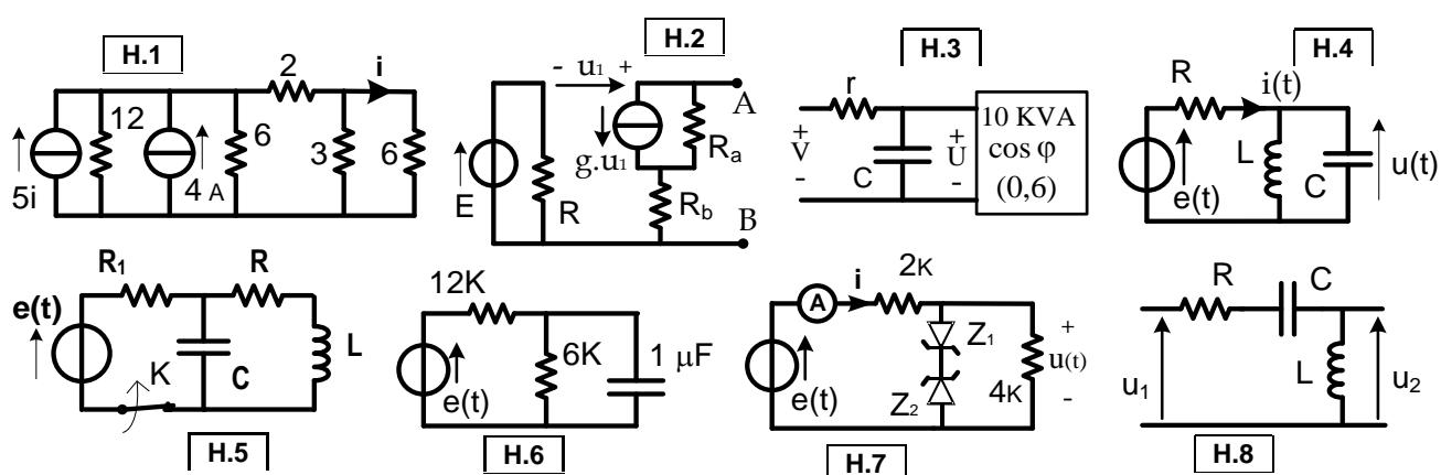
**Bài 5.** Mạch hình (H.5) với các thông số  $R_1=1 \text{ K}\Omega$ ,  $R=2 \text{ K}\Omega$ ,  $L=2 \text{ H}$ ,  $C=0,5 \mu\text{F}$  và  $e(t)=15\cos(1000t-\pi/4)$ . [V]. Tại thời điểm  $t=0$  **khóa K được mở ra**.
