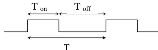
Với  $T$  là chu kỳ điều khiển,  $T_{on}$  là thời gian cấp điện,  $T_{off}$  là thời gian không cấp điện cho lò bằng cách xuất mức 1 (ứng với  $T_{on}$ ) hay mức 0 (ứng với  $T_{off}$ ) ra **Bit 3 của Port 0** để kích dẫn hoặc không dẫn Triac cấp điện cho lò.
