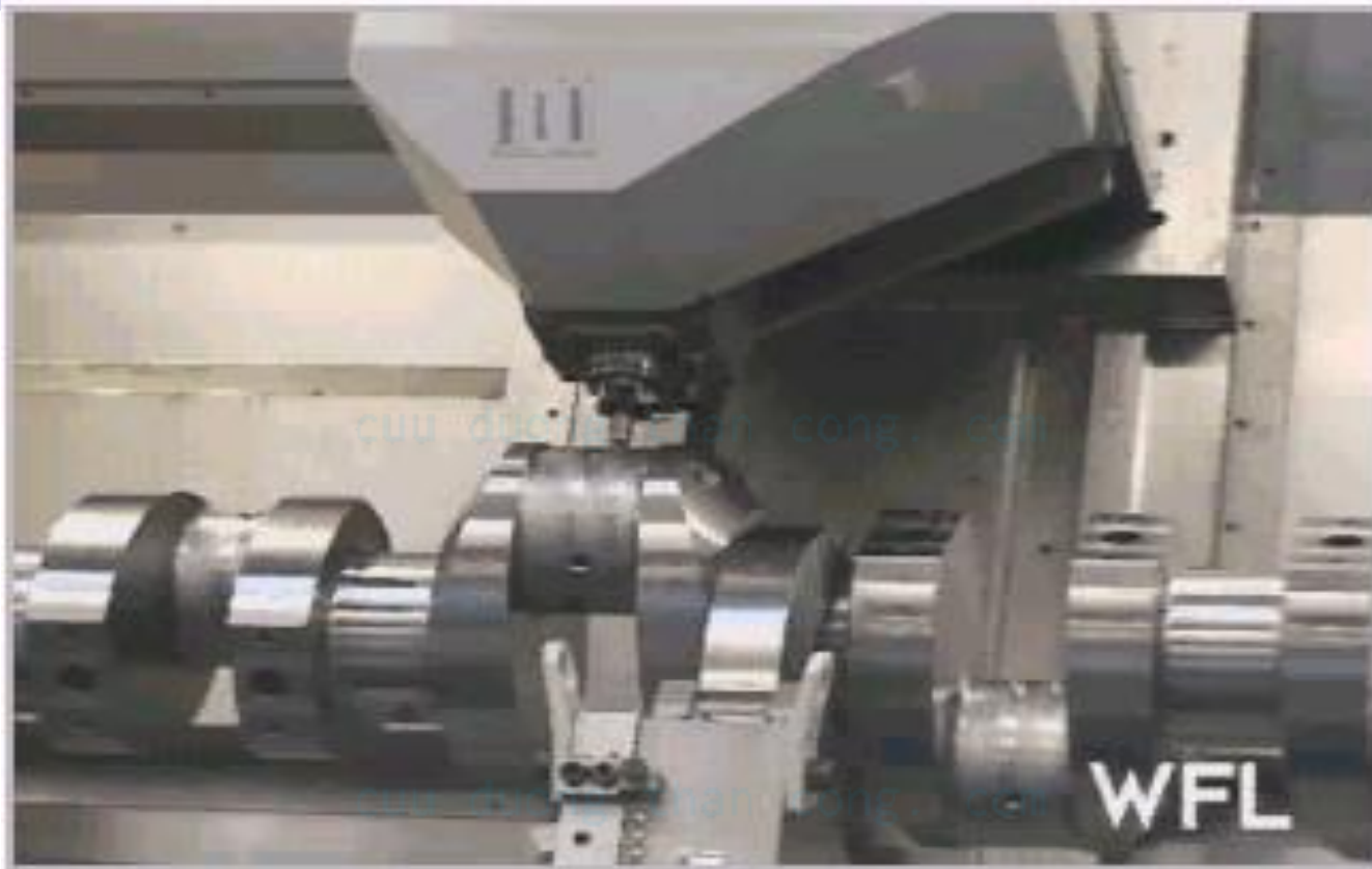
Hình 5.3 T.T Gia công trục khuỷu
